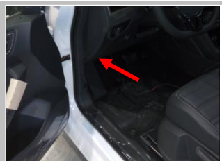
3.18 接解码器信号线：在驾驶室左下角把盖板取下，找到我们要接的线束，（箭头）解码器安装在此处内部固定好防止松动
