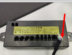
3.23 接控制信号线解码器粉色控制信号线接我司 ECU 的开关延长线中黑色线，尽量靠 ECU 端接线
