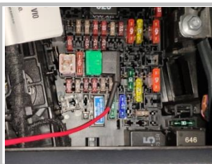
3.14 接正极：用保险丝取电器插上，注意取电器插头方向正确插入取电，如图示意正确安装
