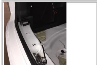
1.7 驱动盒以及拉线布置完成，如图所示，注意：内饰板等对插锁后再还原
