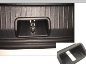
1.9 安装原车后踏盖，并且把产品所配的小盖板安装到原活页位置，如图所示：
