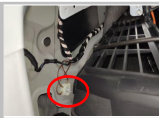
3.15 接负极：在左侧尾箱装饰板内找到原车有搭线的负极连接螺栓柱，把我们的负极线搭上
