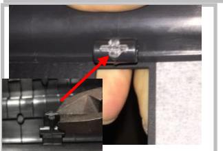
1.10，原车后踏盖需要切割一根定位筋条，如图所示：
