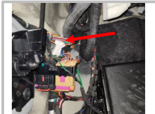
3.19 接解码器信号线：如图角度正视图内正确找到原车黑色线束，拆下黑色胶布；（通往左前门的线束）
