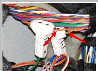
3.21 接解码器信号线：棕棕色线为 CAN-L 要和解码器线束中的绿黑线相接，橙绿色线为 CAN-H 要和解码器线束中的绿线相接
