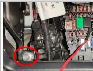
3.17 解码器负极：用解码器负极接此圆圈位置（螺母）连接负极母
